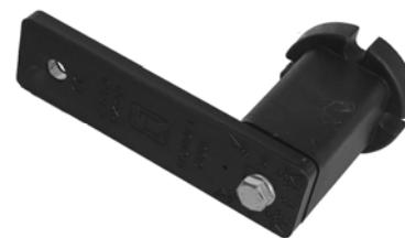
**PX / PX-R** Spannelemente sind aus Glasfaserverstärkten Kunststoff mit Metalleinsatz, hervorragend geeignet für korrosive, feuchte Umgebung. Der Spannwinkel kann bis zu 30° in beiden Richtungen gespannt werden. Die Drehmomente, Pos. „b“ und die Hebelstellung „J“ können aus der Tabelle auf der Seite 20 abgelesen werden. Alle **PX / PX-R** sowie die Kits werden mit Edelstahlschrauben und Muttern (INOX) geliefert. Siehe Seite 18, alle Befestigungssysteme sind auf der Seite 41 zu finden.
