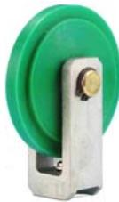
Le KIT est composé d'une Chappe en aluminium équipé d'une roue folle montée sur un axe en acier zingué. La roue folle est en polyéthylène haute densité moléculaire. La visserie utilisée est en acier zingué. Vitesse de travail ≤30 m/min. Température de travail de la roue ≤70°C. Spécifier l'orientation (**H** ou **Y**), par défaut il sera monté avec l'exécution **H**.
