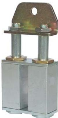
Elément tendeur à double colonne. Les sections carrées sont en aluminium, les jonctions, les colonnes et les bouchons sont en acier zingué, les bagues sont en laiton et la bride en acier zingué.
