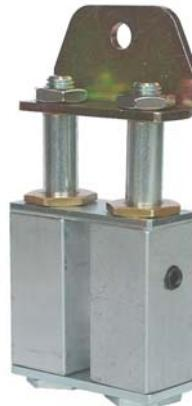
Elément tendeur à double colonne. Les sections carrées sont en aluminium, les jonctions, les colonnes et les bouchons en acier zingué. L'élément tendeur AFB a une vis de pré-tension(vis STEI (N) taille 1 et 2 et une vis TE (Z) taille 3) pour faciliter les opérations de montage.
