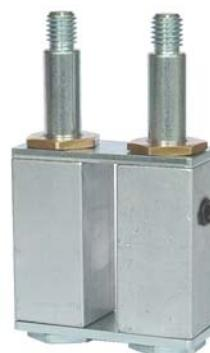
Elément tendeur à double colonne. Les sections carrées sont en aluminium; les jonctions, les colonnes et les bouchons sont en acier zingué. L'élément tendeur ABB a une vis de pré-tension (vis STEI N) de taille 1 et 2 et une vis TE (P) de taille 3 pour faciliter les opérations de montage.
