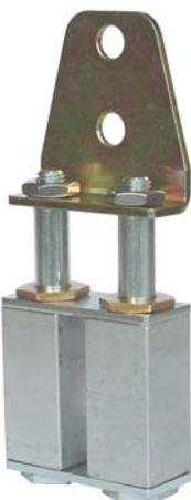
Elément tendeur à double colonne. Les sections carrées sont en aluminium, les jonctions, les colonnes et les bouchons en acier zingué, les anneaux en laiton et la bride en acier zingué.
