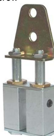
Elément tendeur à double colonne. Les sections carrées sont en aluminium; les jonctions, les colonnes et les bouchons en acier zingué, les anneaux en laiton et la bride en acier zingué. L'élément tendeur ADB a une vis de pré-tension(vis STEI (V) de taille 1 et 2 et une vis TE (Z) de taille 3) pour faciliter les opérations de montage.
